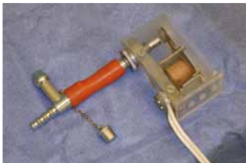
Elektromagnetisch intermitterende duim op T-stuk.
