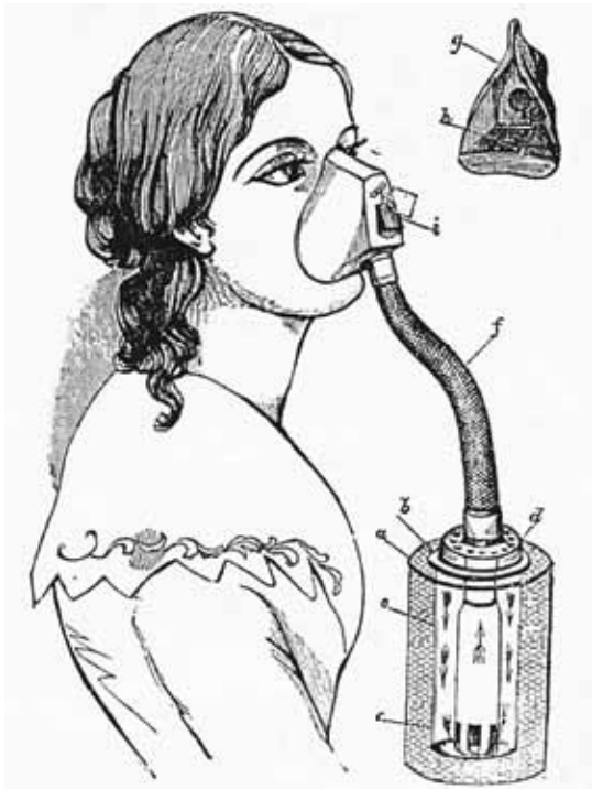
Inhalatieapparaat van Snow voor chloroform of ether.
