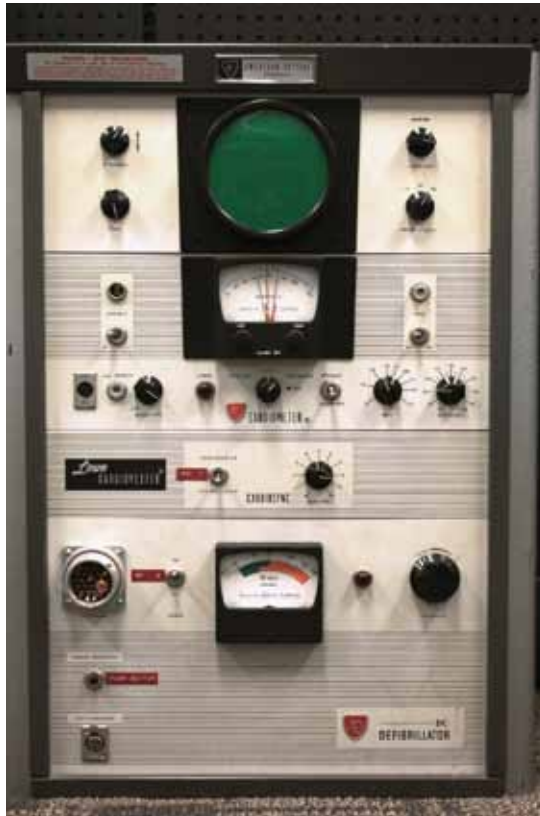
Figuur 2. De eerste gelijkstroomdefibrillator: “Lown defibrillator”, 1960. Exemplaar in Physio-Control museum.
