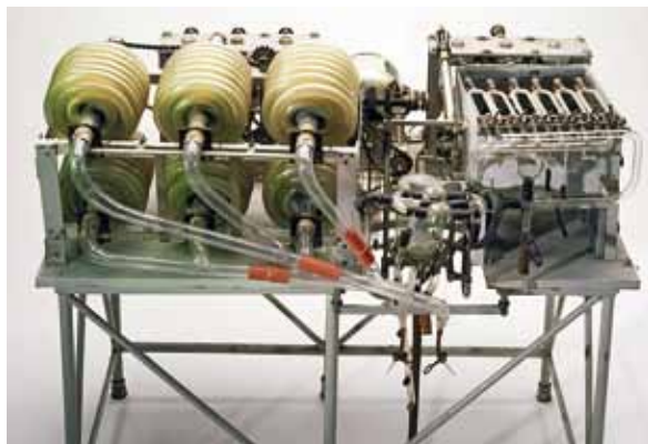
Figuur 1. Het eerste model van de hart-longmachine van Jongbloed uit 1948 die de basis vormde voor een latere hart-longmachine voor klinisch gebruik (eigendom Universiteitsmuseum Utrecht, in bruikleen Boerhaave museum Leiden).
