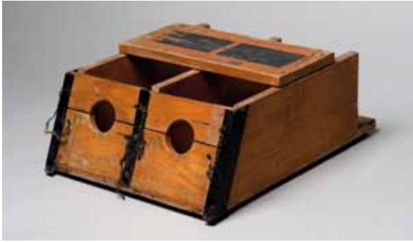
Houten fixatieblok, geschikt voor twee konijnen. Op de zwarte vlakken kunnen met krijt aantekeningen worden gemaakt, ca. 1960.
