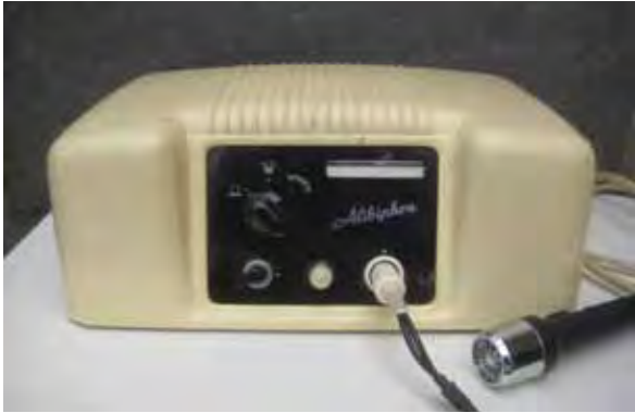
De Alibiphon, het eerste antwoordapparaat voor de huisartspraktijk, met microfoontje om het bandje in te spreken. Komt in 1957 op de markt voor de prijs van f 650,-.
