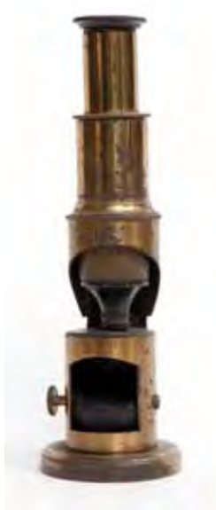
Een zogenaamde trommelmicroscoop, rond 1800; werd met name gebruikt in de biologie.
