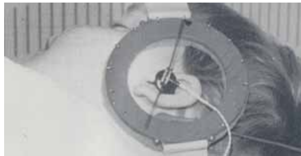
Figuur 1. Elektrocochleografie waarmee bij een baby de gehoorfunctie bepaald kon worden (Leiden, 1974).
