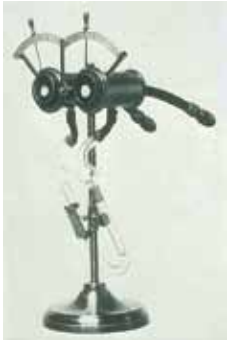
Figuur 3. De rhino(dromo)meter ('air bridge') waarmee de neusademhaling werd gemeten.
