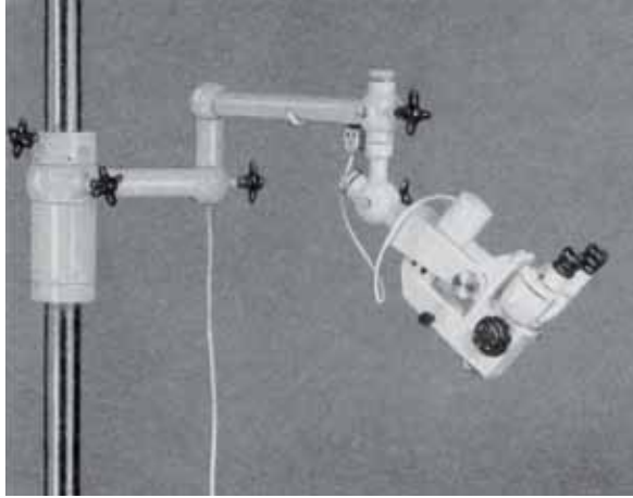
Figuur 1. Rijdbare operatiemicroscop met zwenkarm en verwisselbare optieken, de OPMI 1 van de Zeiss fabrieken in West-Duitsland die voor het eerst gepresenteerd werd op het 5th International Congress of Oto-rhino-laryngology in het Koninklijk Instituut voor de Tropen te Amsterdam in juni 1953.
