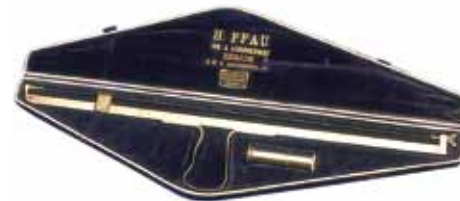
Figuur 2. Het monochord van Struycken, een instrument dat tot de komst van de audiometer algemeen in gebruik was voor de bepaling van de bovengrens van het gehoor.
