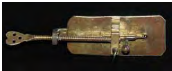
Een Van Leeuwenhoek-microscoop. Het instrument is enkelvoudig: het heeft maar één lens. Het prepraat wordt op het naaldje voor de lens gemonteerd.
