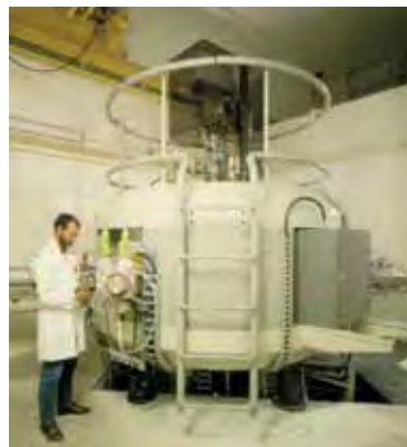
Figuur 2. Een 30 MeV cyclotron, zoals gebruikt voor de productie van radioactieve isotopen (Foto: Centre de Ressources du Cyclotron, Louvain la Neuve, bron: http://www.cyc.ucl.ac.be/Facility/cyclone30.jpg ).
