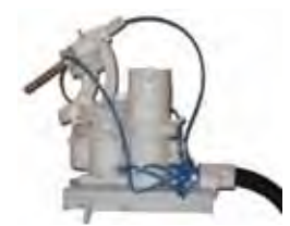
Figuur 4. MR-compatibele robot voor het uitvoeren van transrectale aspiratie van de prostaat.
