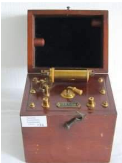
Foto 4. Laag frequent electriseerapparaat rond 1900 (merk onbekend).
